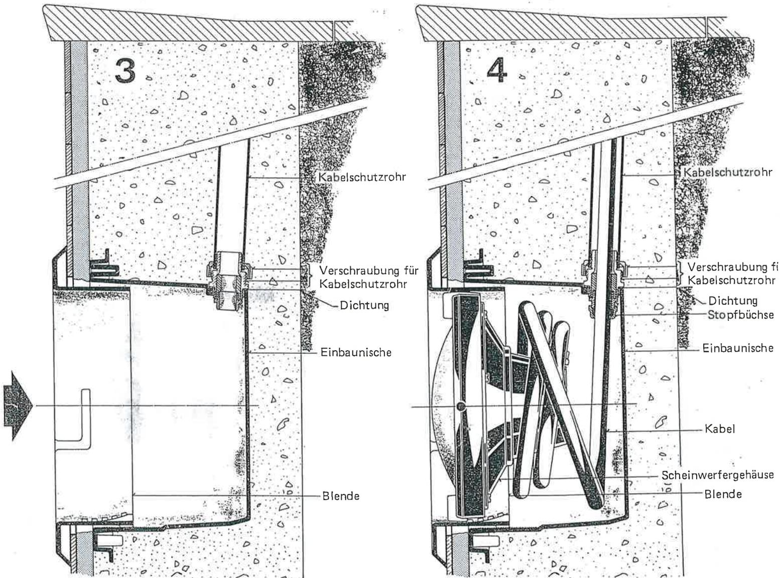
3. Die Abdeckrosette ist nun in die Einbaunische einzuführen, bis sie satt aufliegt. Dank dem Sägeblattverschluss ist die Abdeckrosette nun nicht mehr verschiebbar.
