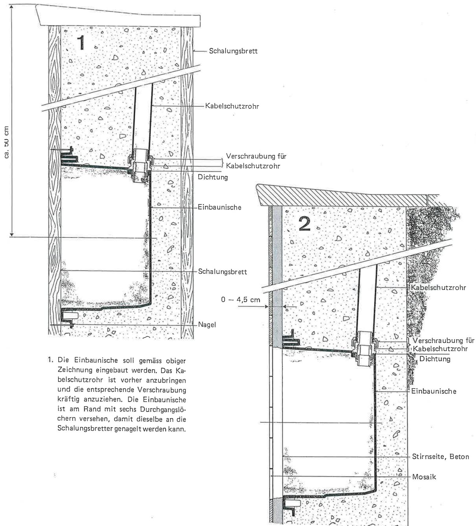
1. Die Einbaunische soll gemäss obiger Zeichnung eingebaut werden. Das Kabelschutzrohr ist vorher anzubringen und die entsprechende Verschraubung kräftig anzuziehen. Die Einbaunische ist am Rand mit sechs Durchgangslöchern versehen, damit dieselbe an die Schalungsbretter genagelt werden kann.
